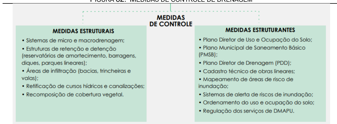
FIGURA 82: MEDIDAS DE CONTROLE DE DRENAGEM
